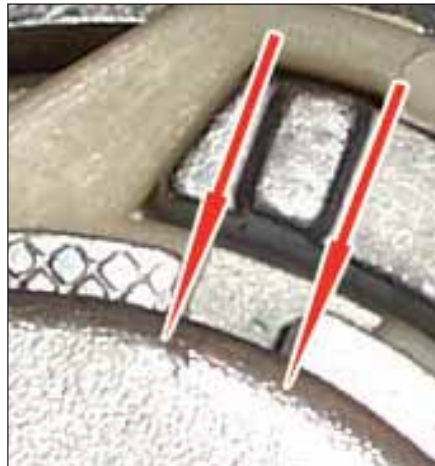
Bild 4: Beide Kerben stehen in der Aussparung (Pfeile). Die Einstellung ist richtig!
