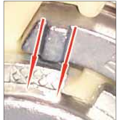
Bild 5: Beide Kerben stehen außerhalb der Aussparung (Pfeile). Die Einstellung muss korrigiert werden!
