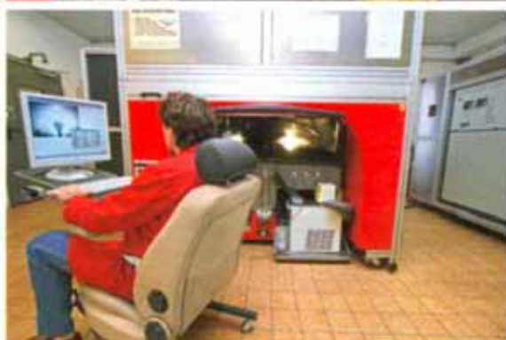
Oben: Mit einer speziellen Schleifpolitur wurde vor jedem Testdurchgang die Scheibe gereinigt. Unten: Maßstab für die Reinigungsbewertung ist das mittels einer Videokamera während der Wasch- und Wischzyklen gemessene Streulicht
